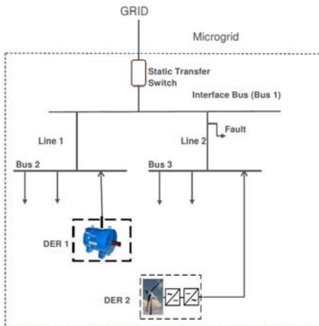
Fig. 2 : Sympathetic Tripping
