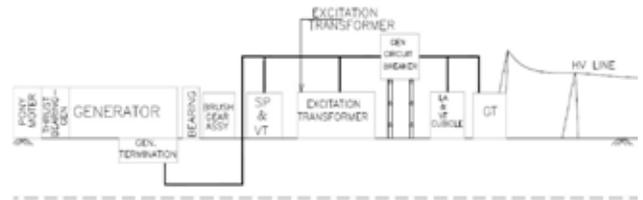
Fig. 3 : Synchronous Condenser Scheme
